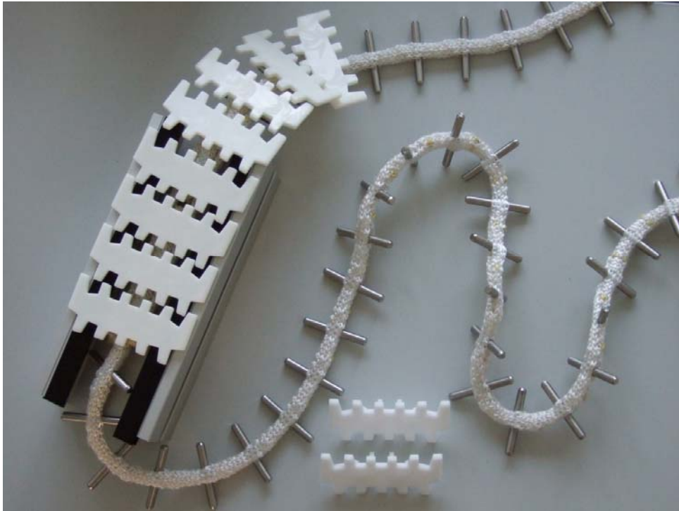
Abb. 6: Muster gewirkte Tragseilkette mit Führungsprofil und Tragplatten [Quelle TU Chemnitz]
