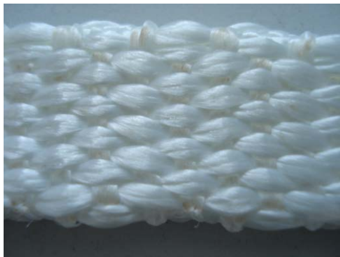
Abb. 8: Gewebe Trägerstruktur [Quelle: TU Chemnitz]
